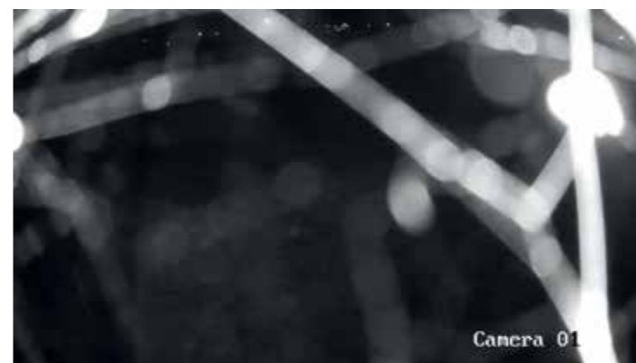
Rys. 3. Kamera z silnie prześwietlonymi pajęczynami na obiektywie
