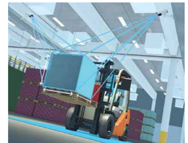
Fot. 2. Rozwiązanie Package Measurement automatycznie rejestruje wagę i objętość pakowanych przedmiotów i integruje te informacje z SAP
