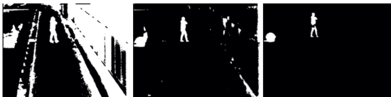
Rys. 1. Obraz termowizyjny po operacji binaryzacji wykonany dla trzech różnych wartości progowania
