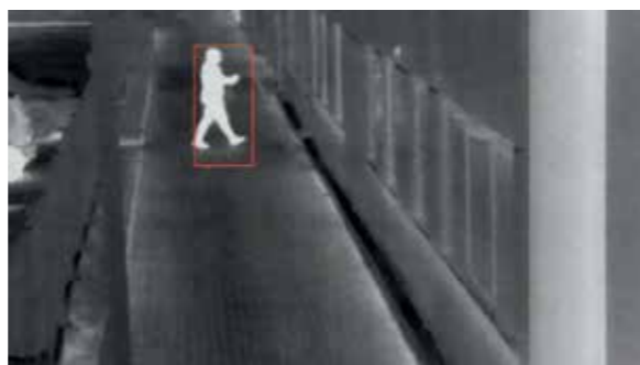
Rys. 6. Analiza wizyjna pracująca w kamerze termowizyjnej. Binarystacja obrazu termowizyjnego została zaprezentowana na rys. 1
