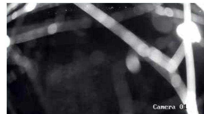
Rys. 4. Kamera z silnie prześwietlonym pająkiem na obiektywie. Wykrycie obiektów jest niemożliwe – system jest w takim momencie niezdolny do pracy
