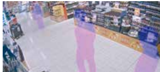
Fot. 5. Przykład dynamicznego maskowania - anonimizacji obrazu Źródło: materiały Axis Communications
