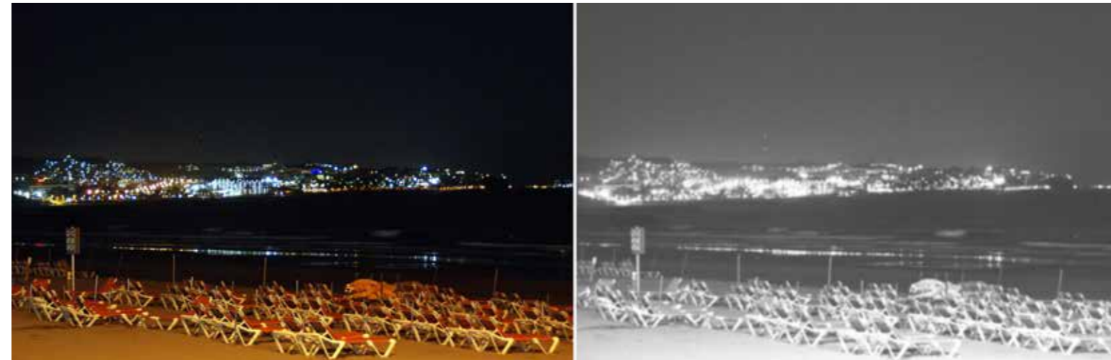
Fot. 1. Obrazy w trybie kolorowym i czarno-białym (odsunięty filtr IR). W trybie czarno-białym widoczny jest wzrost czułości przy jednoczesnej utracie ostrości w wyniku braku korekcji obiektywu dla pasma podczerwieni. Autor: Piotr Rogalewski
