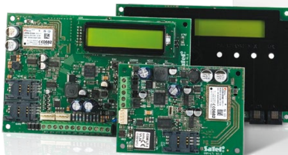
GSM LT-1 modul GSM zastępujący linię telefoniczną
