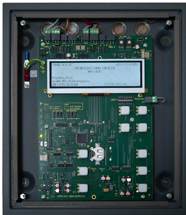
Ryc. 2. Widok UZSiO Wyniesiony Panel Obsługi typu WPO 3000 widok płyty głównej Źródło: CNBOP-PIB.
