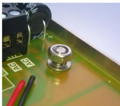
SPOSÓB POLUZOWANIA NAKRĘTEK GÓRNYCH PRZY WYMIANIE ETYKIETY ZDJĘCIE NR 2
