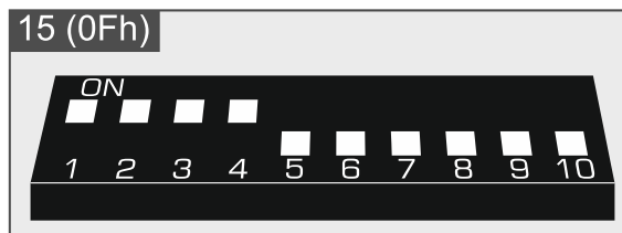
Rys. 12. Ustawienie przełączników DIP-switch w ekspanderze INT-O.
