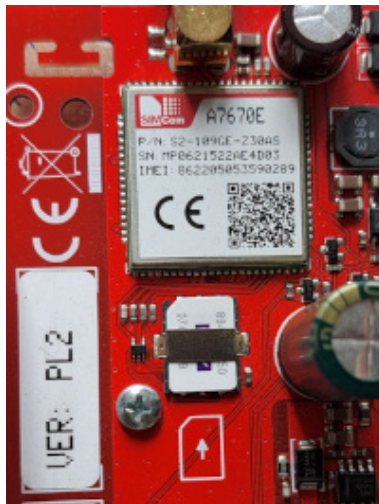
Rysunek 5: Instalacja karty NanoSIM w PRiMA64LTEWL.
