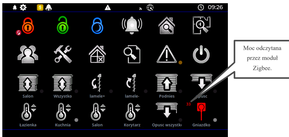
7. Widok włączonego widgetu z aktywnym pomiarem mocy.
