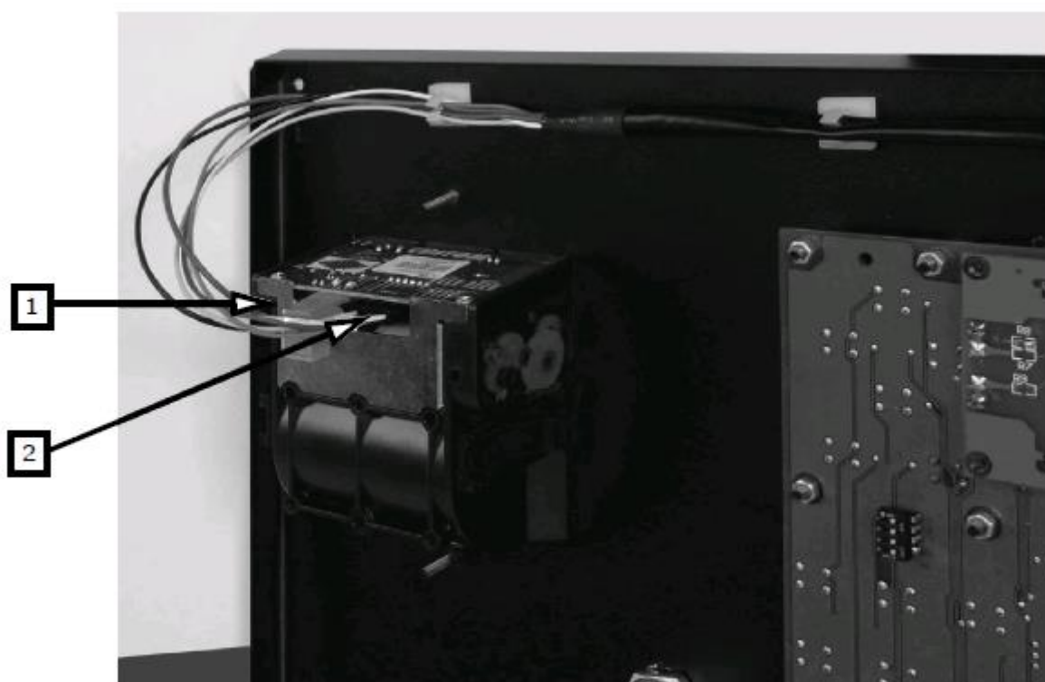
Rysunek 20 - Moduł SmartLoop/PRN (drukarka) zamontowany na płycie czołowej centrali
