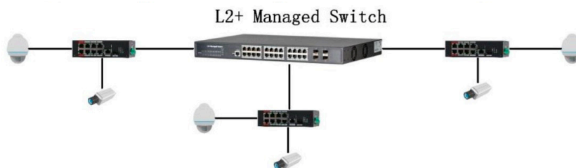
Rysunek 1-2 Typowa scena interakcji sieciowych 8 portowego przełącznika
