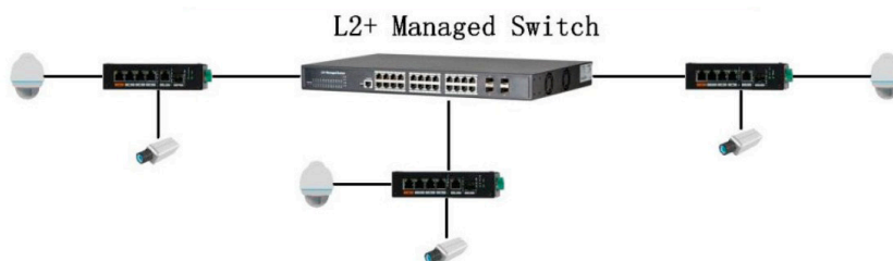
Rysunek 1-2 Typowa scena interakcji sieciowych 8 portowego przełącznika
