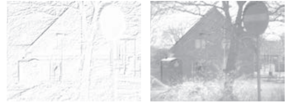
Rys. 4. Obraz po wykryciu krawędzi maską Roberta i fuzja z obrazem z kamery światła widzialnego (źródło: Baza TNO, modyfikacja obrazu: Jakub Sobek)
