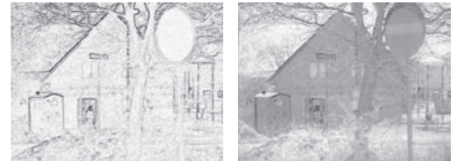
Rys. 5. Obraz po wykryciu krawędzi maską Sobela i fuzja z obrazem z kamery światła widzialnego (źródło: Baza TNO, modyfikacja obrazu: Jakub Sobek)
