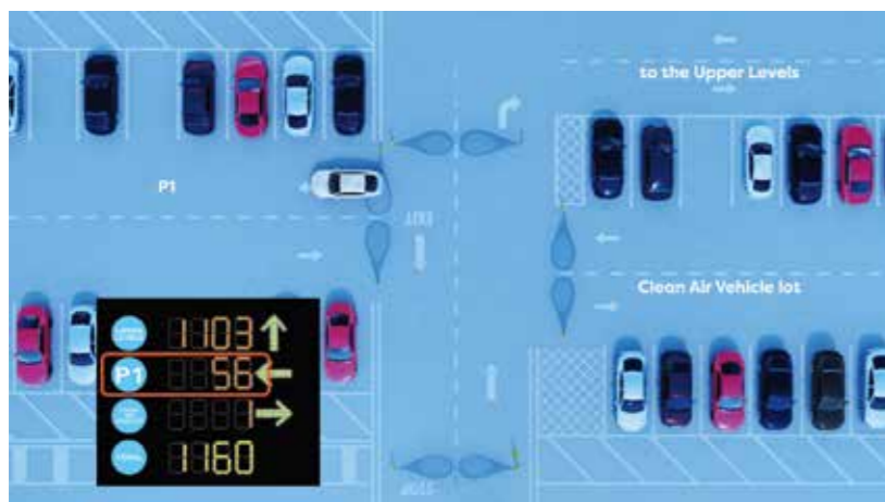
Rys. 1. Czujkę OVS-01CC można wykorzystać w systemach zajętości miejsc parkingowych. Kierowca, wjeżdżając na teren parkingu, wie, w którym sektorze znajdzie wolne miejsce. Czujki są zamontowane przy pasach ruchu przeznaczonych do wjazdu i wyjazdu.
