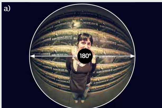
Rys. 1. Przykłady rzutowania światła przez obiektyw typu „rybie oko” na przetwornik: a) obraz jest wpisany w przetwornik, b) przetwornik jest wpisany w obraz za pomocą obiektywu panoramoficznego o zwiększonym stosunku piksel/kąt w strefie B [3]
