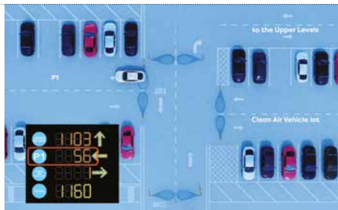
Zastosowanie modelu OVS-01CC: kierowca, wjeżdżając na teren parkingowy, wie, w którym sektorze znajdzie wolne miejsce. Czujki są zamontowane przy pasach ruchu przeznaczonych do wjazdu i wyjazdu
