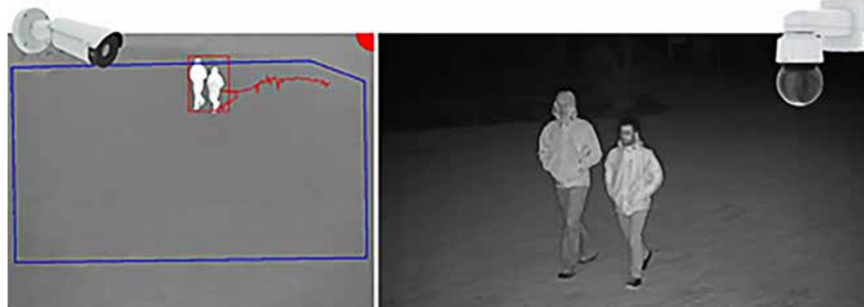
Na obrazach nocnych pochodzących ze stałopozycyjnej kamery termowizyjnej (po lewej) i kamery PTZ (po prawej) przedstawiono efekt współpracy obu tych kamer z aplikacją AXIS Perimeter Defender PTZ Autotracking
