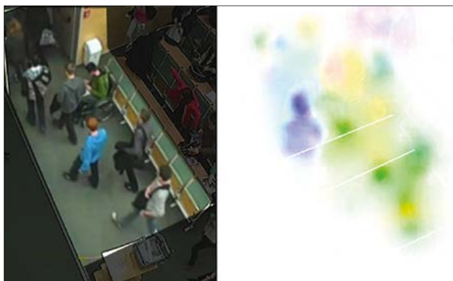
Fot. 2. Przykład działania metody przepływu optycznego: barwy wskazują kierunek ruchu, intensywność koloru oznacza prędkość
