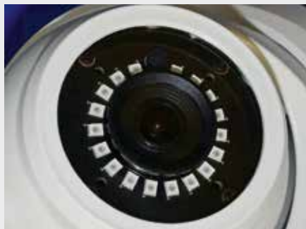
fol. 5 Kamera z sekcją diod LED szerokokątnych
