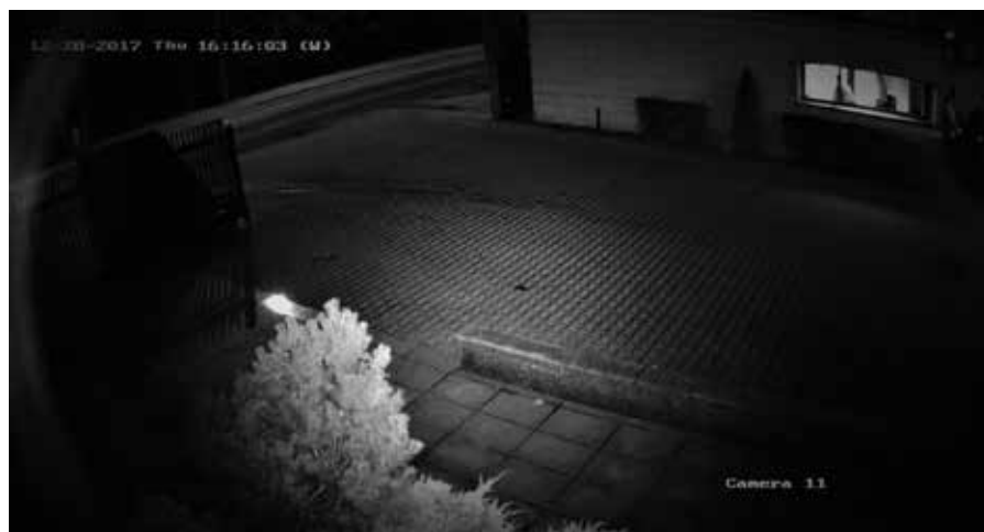
fot. 1 Kamera ze zbyt wąskim kątem świecenia
