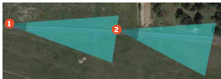
Rys. 4. Przykład BŁĘDNEGO rozmieszczenia kamer. Martwa strefa kamery nr 2 znajduje się poza strefą efektywnego działania kamery nr 1.
