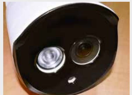
fol. 7 Miniaturowa kamera z diodami COB
