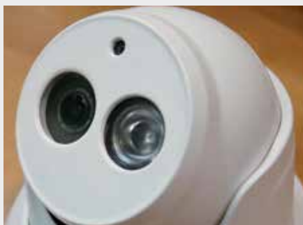
fot. 11 Diody z odbłyśnikiem w obudowie typu flat-face
